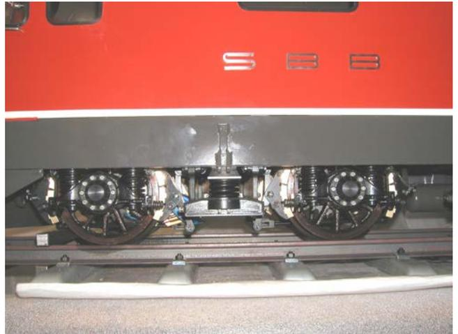
Detail Drehgestell, Kastenabstützung, Bremsen
